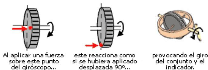
**Fig.2.8.4 - Funcionamiento del indicador de viraje.**
